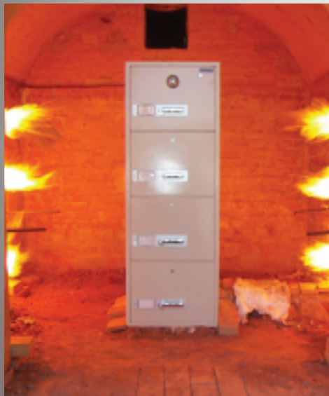
1010 C'lik fırında yangın testi
