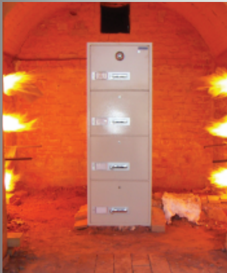
1010 C lik fırında yangın testi
